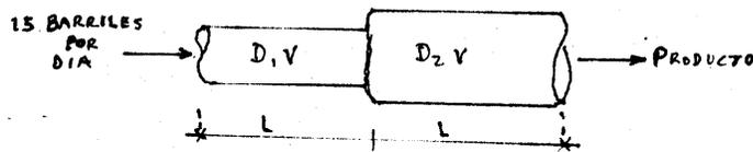
Fig. 4.4.2 Reactor con diámetros distintos pero igual longitud.
