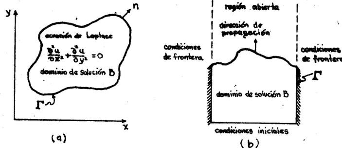
fig. 15. representación esquemática del dominio de solución.
