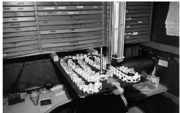
Figura 21.- Bandeja con pista cambiadora de muestras en un cuarto magnéticamente aislado.
