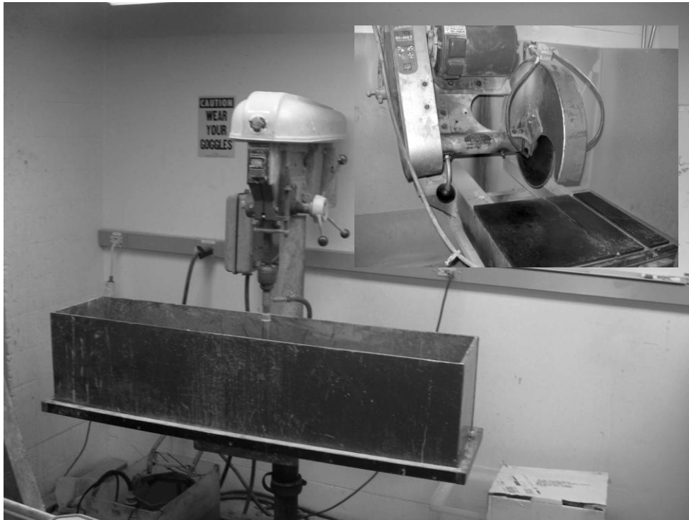
Figura 14.- Perforadora y sierra de laboratorio con sistema de enfriamiento a base de agua.
