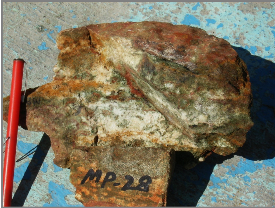
Foto 25. Evidencias de alteración retrógrada en una muestra de mano tomada de una de las pequeñas obras mineras encontradas en el área de estudio, la cual presenta clorita, tremolita-actinolita y óxidos de hierro (Hematita-Limonita-Pirita oxidada).
