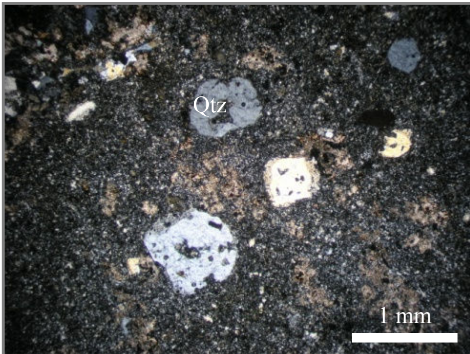
Foto 10. Microfotografía: Muestra LC-M-4, con luz polarizada a 4x. Se pueden observar varios cristales de cuarzo subhedral <1 mm, en una matriz ligeramente silicificada, con presencia de óxidos de hierro y minerales opacos. Tipo de roca: Riolita.
