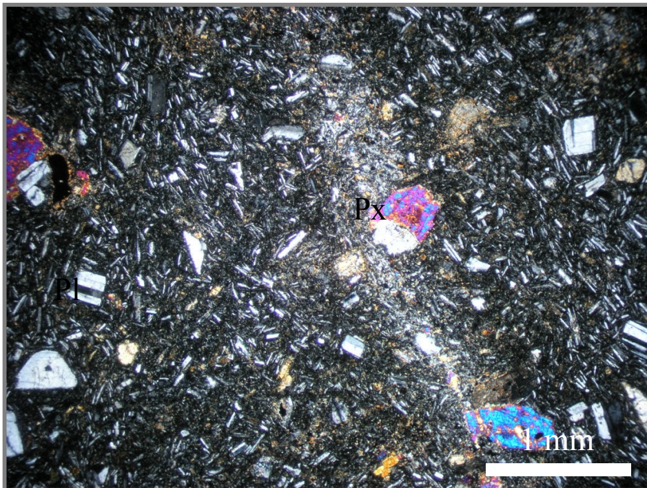
Foto 18. Microfotografía: Muestra LC-M-1, con luz polarizada a 4x. Muestra de roca de composición andesítica, presenta una textura microporfírica con feno y microcristales de plagioclasas (Oligoclasa-Andesina) y piroxenos. Se puede apreciar una microfractura rellena de sulfuros (pirita-pirrotita).
