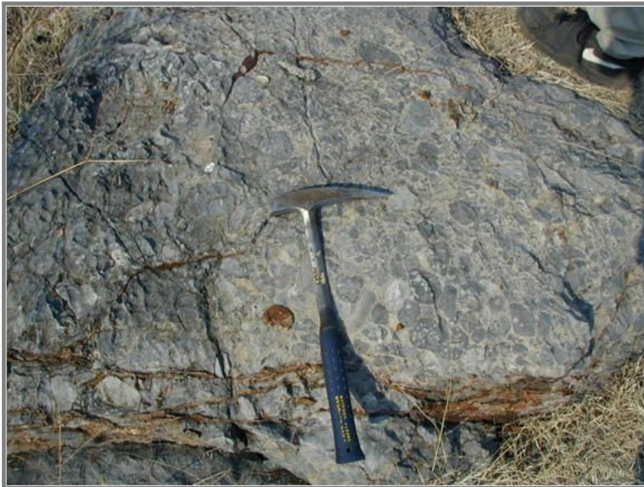
Foto 6. Afloramiento del conglomerado calcáreo (Fm. Balsas), cementado en una matriz carbonatada, ubicados hacia la zona norte y este del área de estudio.
