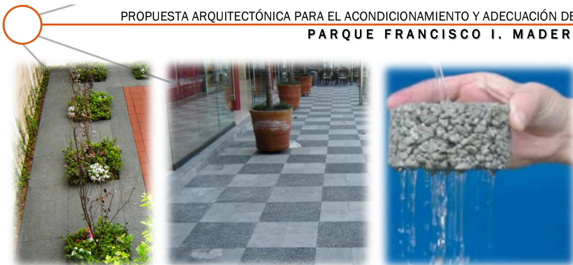
Figura 63: Aplicación del concreto ecológico Ecocrete Fuente: www.ecocrete.com.mx
