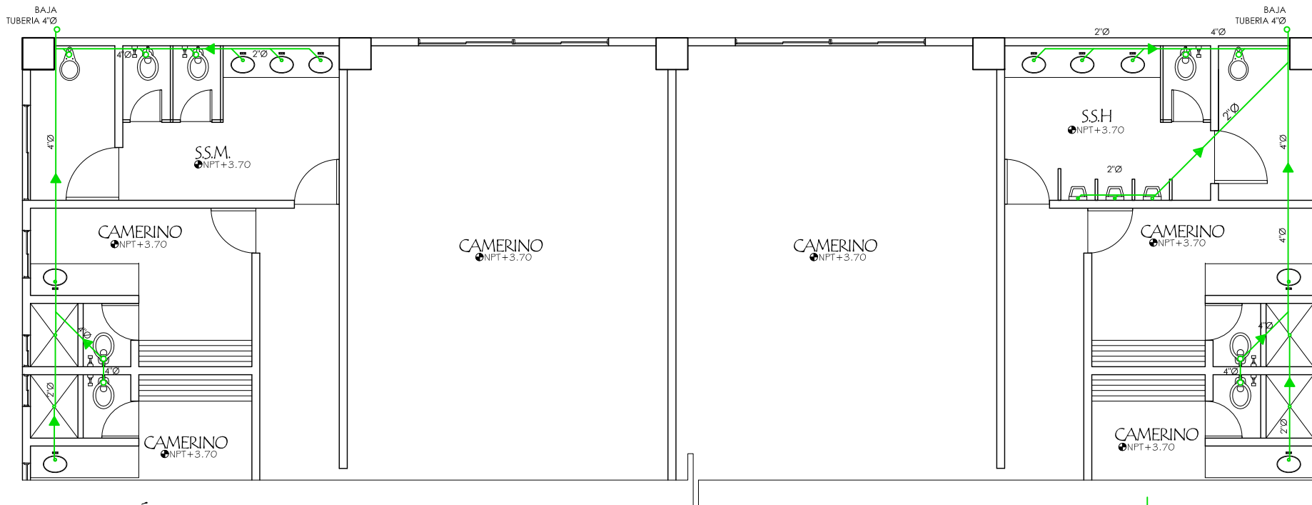
INSTALACIÓN SANITARIA PLANTA ALTA ESC. 1:100
