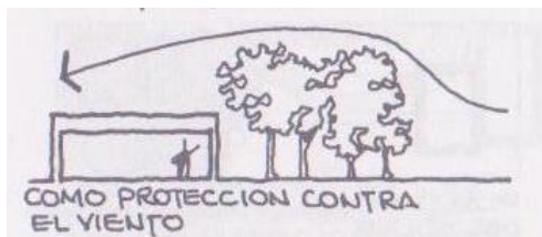
Fig. 2.15. Protección contra el viento S/E
