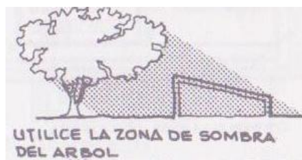
Fig. 2.13. Protección contra el sol S/E
