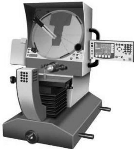
Figura 4.1 Vista de un comparador óptico
