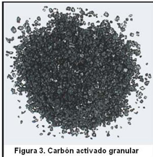
Figura 3. Carbón activado granular
