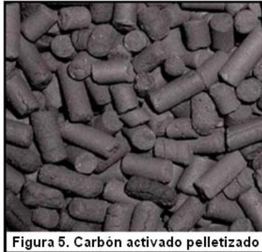
Los pellets suelen ser cilíndricos debido a que normalmente se producen por extrusión. Su principal ventaja consiste en que causan una menor caída de presión que los carbones granulares, cosa que los hace muy útiles en la purificación de aire y otros gases en los que existe una baja presión disponible. Sin embargo en ocasiones también se aplican en fase líquida. Comercialmente se encuentran en diámetros de 0.8 a 5 mm, siendo el de 4 mm el más común.
