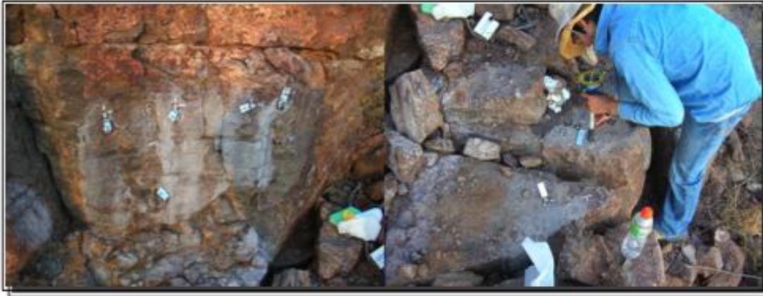
Fig. 36 Núcleos perforados in-situ (foto izquierda) y orientación de núcleos con el orientador Pomeroy con aditamento para brújula Brunton (foto derecha).
