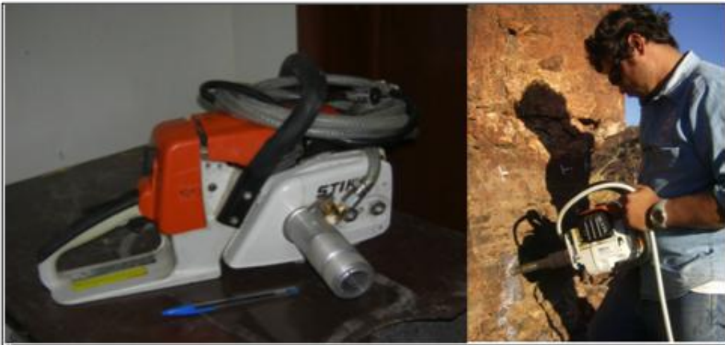
Fig. 35 Nucleadora marca STIHL modelo MS 260. Utiliza una broca de diamante y un sistema de enfriado a base de agua.
