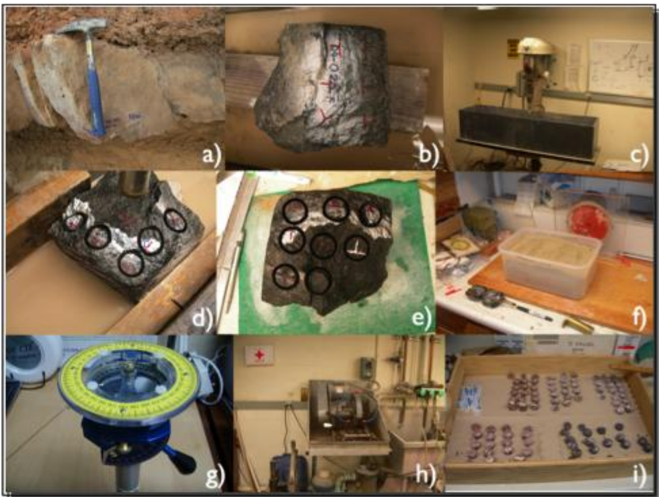
Fig. 34 Mosaico de imágenes que muestran el procedimiento para preparar muestras para el estudio de fábrica. a) Toma de la muestra orientada, b) Planeación de los sitios a perforar, c) Nucleadora fija del laboratorio de paleomagnetismo de Caltech, d) La muestra se coloca en la tina de la nucleadora y se fija con tabiques de madera, e) núcleos listos para orientarse, f) caja de arena y brújula brunton utilizados para orientar el bloque perforado, g) Orientador marca Pomeroy, h) Cortadora con enfriador a base de agua, i) Núcleos listos para las pruebas paleomagnéticas.
