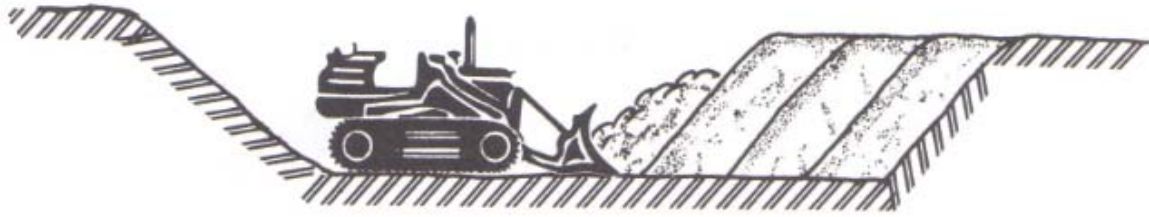
Imagen 11. Relleno tipo zanja.
