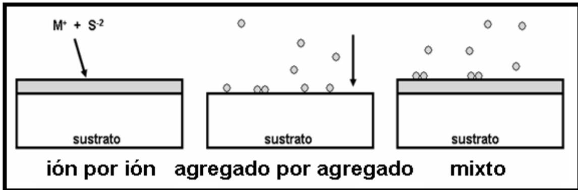
Figura 8. Representación esquemática de los diferentes mecanismos de depósito que pueden suceder en el DBQ [40].
