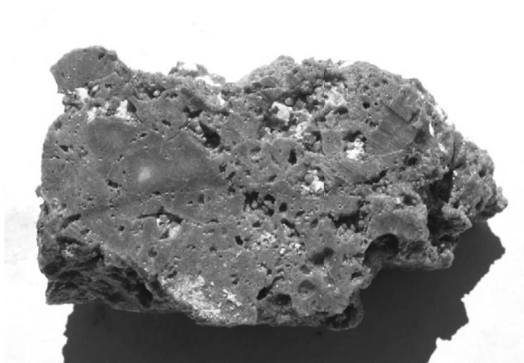
Foto 4.- Muestra de roca con alteración SV; las cavidades están rellenas con alunita.
