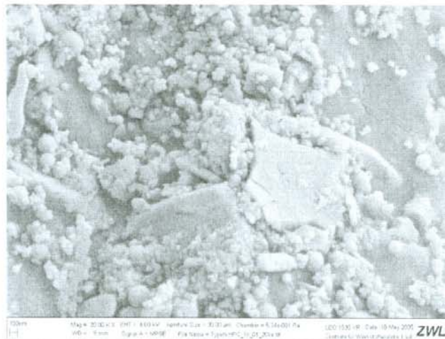
Fig. 18. Se observa el concreto de alta efectividad a nivel nano ya hidratado.
