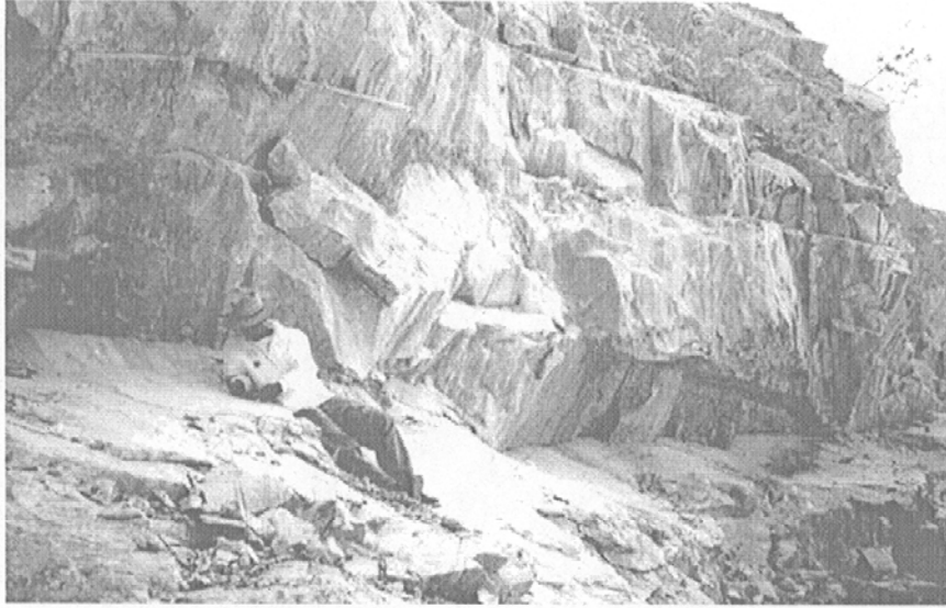
Imagen 7.1.- Proceso de mapeo de fracturas, donde se recolectaron datos de rumbo, buzamiento, persistencia y espaciamiento.
