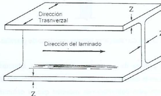
Figura 2.3.5 Dirección típica del laminado en secciones I
