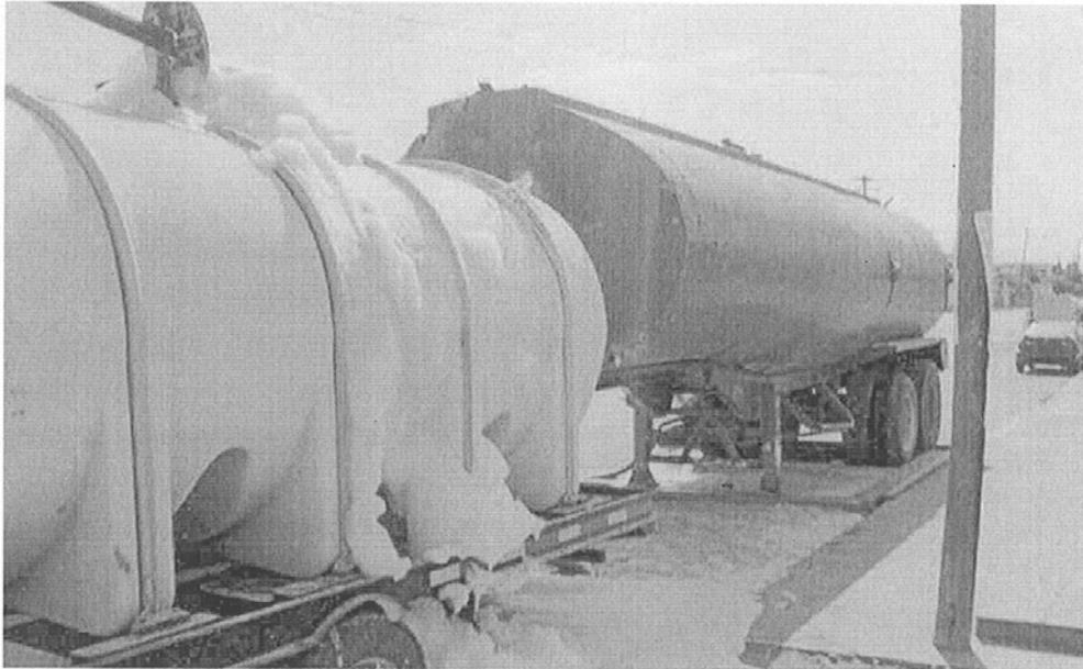
Foto 5.7 Proceso de mezcla de bentonita sódica de Wyoming con agua dulce
